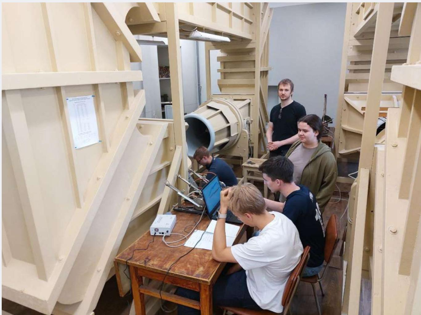
В программу практики входило знакомство с малой и большой аэродинамическими трубами СПбПУ, с приборами для измерения давления и скорости воздушного потока. Школьники познакомились с технологией измерения скорости с помощью трубки Пито-Прандтля и термоанемометра. В ходе серии модельных экспериментов были выполнены оценки влияния угла атаки на аэродинамические силы, при этом подъемная сила и сила сопротивления, действующие на крыловой профиль, измерялись с помощью тензометрических датчиков.
